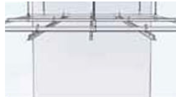
5. 메인 T-BAR 시공
